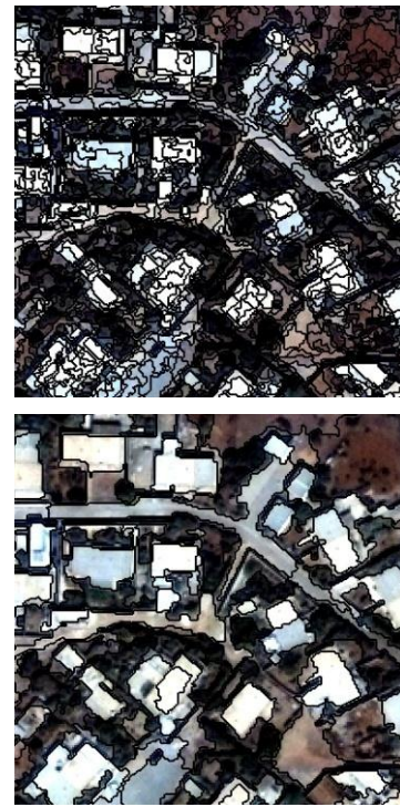
Fig. 3 Segmentation multi-résolution. Haut : Echelle 10. Bas : Echelle 55.
