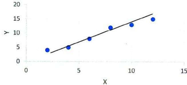
✓ **La méthode des moyennes mobiles** : le principe de calcul ressemble à celui des moyennes échelonnées (Médiane pour les  $x_i$  et moyenne arithmétique pour les  $y_i$ ). La différence se situe dans la formation des sous-ensembles qui ne sont pas strictement distincts les uns des autres. Autrement dit, les valeurs se répètent dans plusieurs sous-ensembles.
