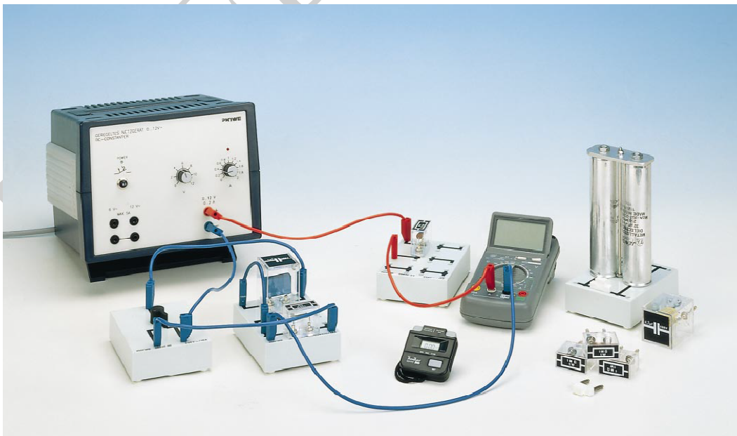
Figure 0: Dispositif expérimental pour la charge et décharge d'un condensateur
