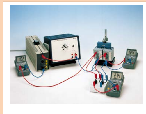
Etude d'un transformateur
