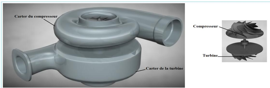
FIGURE 3.9 – Turbocompresseur centrifuge.
