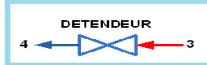
FIGURE 3.37 – Schématisation d'un détendeur.
